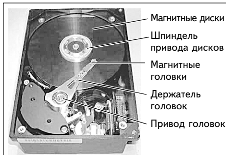
Илл. 1. Внутреннее строение винчестера.
